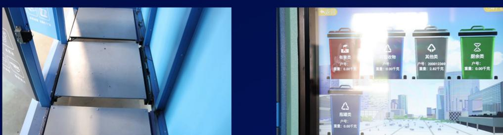
5-2-、电子称：投递垃圾后，自动称重，重量最高350kg，最小称重10克。投递过后系统自动转化成积分存入用户账号内。
