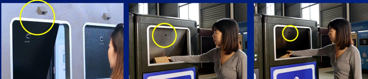
5-5-、感应装置：当人投递垃圾时长过长，超过预定时间，那么感应探头检测到人体，会自动再次开启投口不会关闭。用户可放心继续操作,当投口感受到外力时也会自动二次开启
