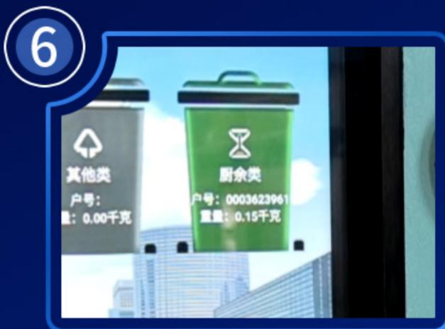
6 投递过后门自动关闭, 系统自动称重, 重量将由后台自动转化成积分。
